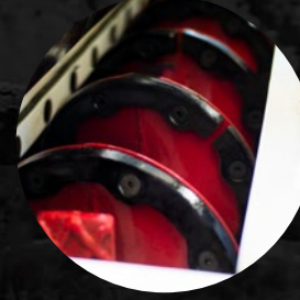
◀ Gusano mezclador de 11" de diámetro con pastillas de recubrimiento de tungsteno
