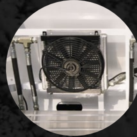
◀ Sistema de enfriamiento
